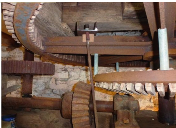
Les « tirants de liaison » & les cales en tubes
